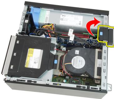
5. Drücken Sie den Entriegelungshebel vorsichtig von der PCIe x16-Karte weg, bis Sie die Sicherungslasche von der Einbuchtung in der Karte lösen. Dann ziehen Sie die Karte vorsichtig nach oben und aus ihrem Anschluss und entfernen sie aus dem Computer.
