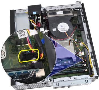
6. Lösen Sie das Kabel der Eingabe/Ausgabe-Platine bzw. das FlyWire-Kabel von der Führung am Kühlkörper.
