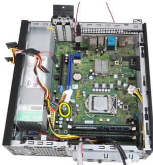
12. Schieben Sie die Systemplatine zur Vorderseite des Computers.
