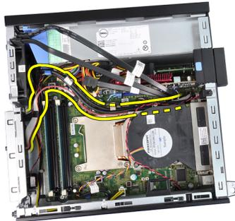
6. Trennen Sie die Eingabe/Ausgabe-Platine/das FlyWire-Kabel von der Systemplatine.
