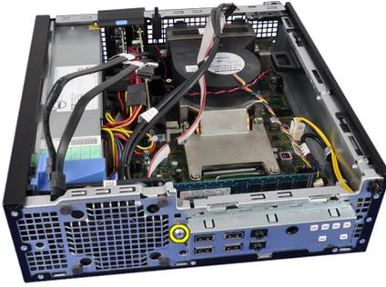
8. Schieben Sie die Eingabe/Ausgabe-Platine zur Sicherung am Gehäuse auf die rechte Seite des Computers.
