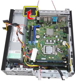
10. Entfernen Sie mit einem Kreuzschlitzschraubenzieher die Schrauben, mit denen die Systemplatine am Gehäuse befestigt wird.
