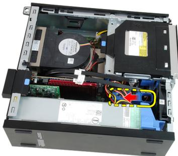
6. Drehen Sie den Laufwerkträger am Griff nach oben und heben Sie den Laufwerkträger vom Gehäuse weg.
