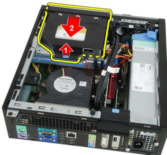
5. Entfernen Sie das optische Laufwerk von der Halterung.
