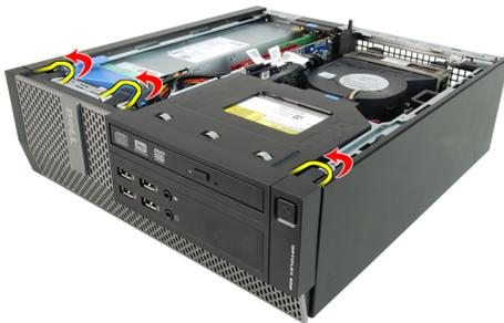
4. Drehen Sie die Verkleidung seitlich vom Computer weg, um die Haken auf der gegenüberliegenden Seite der Verkleidung aus dem Gehäuse zu entfernen.
