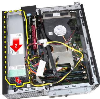
11. Heben Sie das Netzteil aus dem Computer heraus.
