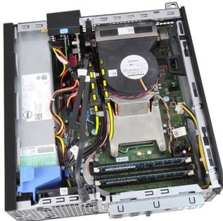
7. Lösen Sie mit einem Kreuzschlitzschraubenzieher die unverlierbaren Schrauben (1 > 2 > 3 > 4), mit denen die Kühlkörper und Lüfterbaugruppe an der Systemplatine befestigt wird.
