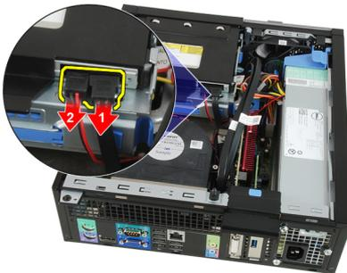
4. Heben Sie die blaue Lasche an und schieben Sie das optische Laufwerk nach innen, um es vom Computer zu entfernen.
