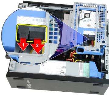
8. Entfernen Sie den Laufwerkträger aus dem Computer.
