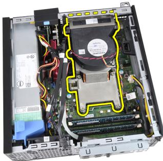
9. Drücken Sie den Entriegelungshebel herunter und bewegen Sie ihn dann nach außen, um ihn von dem Rückhaltehaken zu lösen, der ihn sichert.
