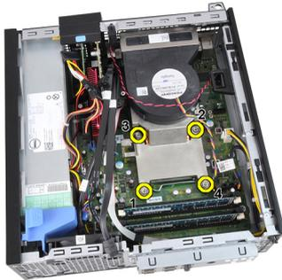
8. Heben Sie die Kühlkörper- und Lüfterbaugruppe vorsichtig an und entfernen Sie sie vom Computer. Legen Sie die Baugruppe mit nach unten gerichtetem Lüfter und nach oben weisender Wärmeleitpaste hin.
