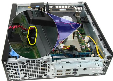
4. Schieben Sie den Eingriffschalter nach innen und entfernen Sie ihn aus dem Gehäuse.
