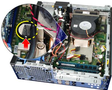
5. Nehmen Sie die Knopfzellenbatterie aus dem Computer und entsorgen Sie sie ordnungsgemäß.
