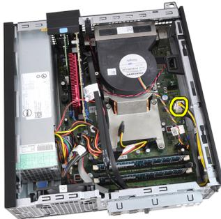
7. Trennen Sie das 4-polige Stromversorgungskabel von der Gehäuseklammer.
