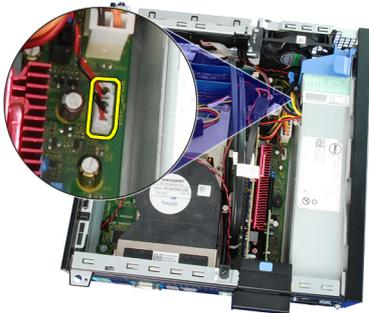
6. Lösen Sie das Kabel des internen Lautsprechers aus der Klammer des Lüfterschutzes.
