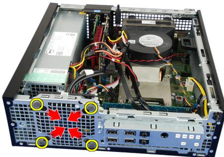
8. Heben Sie den Systemlüfter vom Computer und entfernen Sie ihn.
